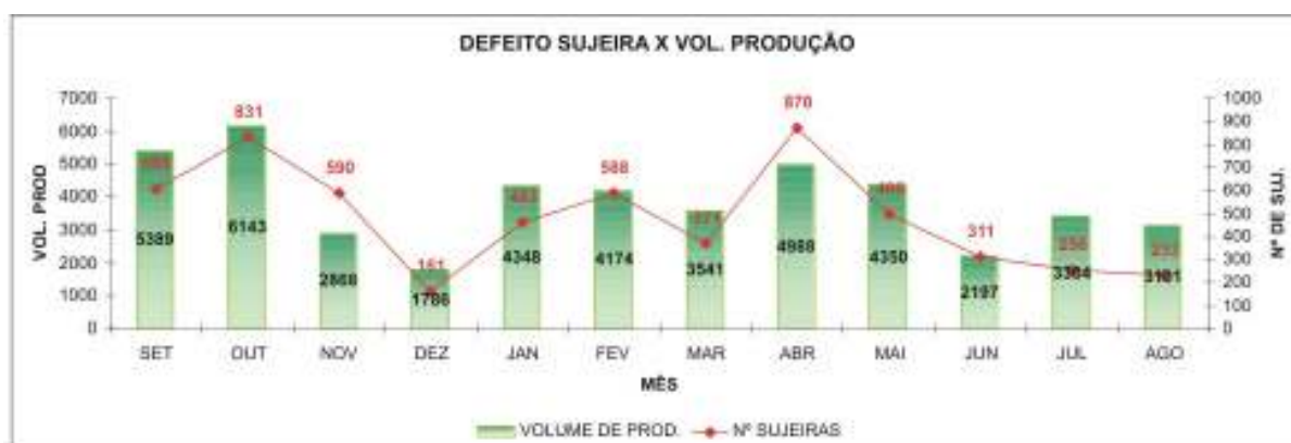
Figura 1 - Quantidade de sujeira em relação ao volume de produção (Fonte Montadora de Veículo)
