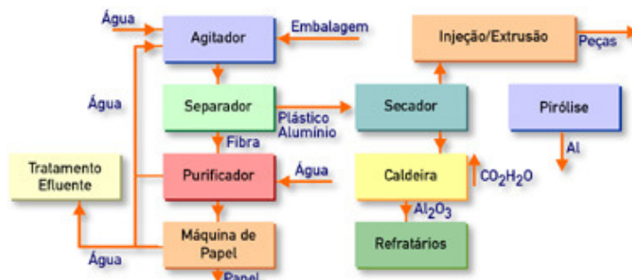
Figura 3 - Desenho Esquemático da Reciclagem das Embalagens Tetra Pak
