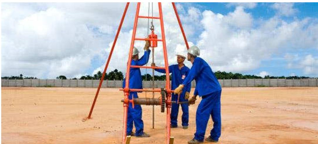
**Figura 05:** Execução do ensaio SPT
