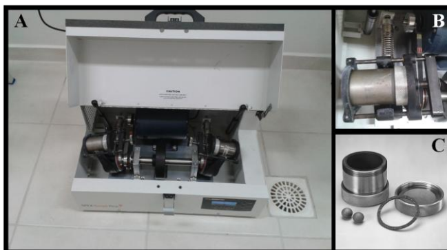
Figura 10. Imagem da visão panorâmica do moinho do tipo Mixer SPEX 8000D (A); detalhe da localização do recipiente no interior do moinho (B) e exemplo de recipiente e bolas utilizadas neste tipo de equipamento (C)
