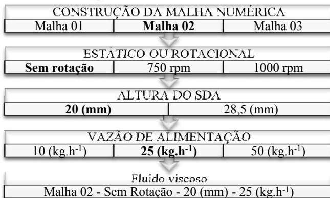
Figura 4.12: Diagrama esquemático para ilustração da sequencia de etapas na obtenção dos resultados de simulação em CFD durante o desenvolvimento e otimização do SDA.
