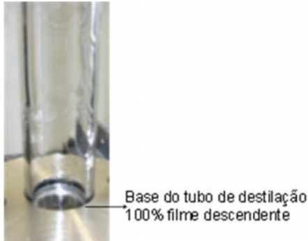
Figura 4.9: Resultado experimental para avaliação da eficiência de manutenção do filme líquido descendente sobre a superfície evaporante para SDA com 20 mm de altura.
