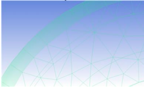
Figura 4.15: Ampliação na Figura (4.14) detalhando a malha prismática e tetraédrica.
