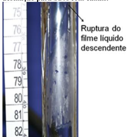
Figura 4.4: Filme líquido descendente nas paredes do tubo de destilação para SDA com canais.
