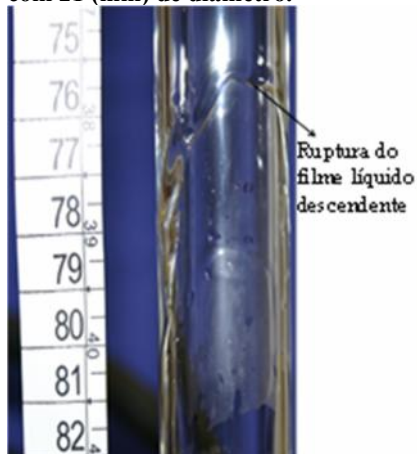
Figura 4.6: Ruptura do filme líquido descendente para o SDA com 21 (mm) de diâmetro.
