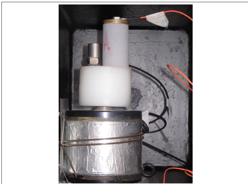
Figura 21 – Bancada para medição do módulo de Young: detalhe da câmara de vácuo.
