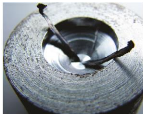
Broca tipo Standard de metal-duro Velocidade de corte: 10 m/min Avanço: 0,03 mm
