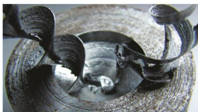
Broca tipo A Velocidade de corte: 10 m/min Avanço: 0,03 mm
