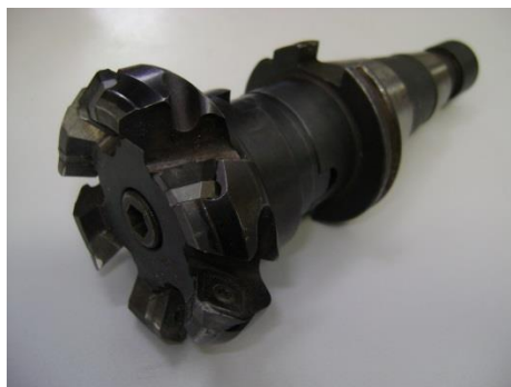
Figura 43 - Fresa para facear Coromill 245L com 6 pastilhas de metal-duro.
