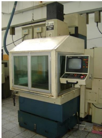
Figura 42 - Fresadora ROMI POLARIS F400 do Laboratório de Mecânica de Precisão (LMP)-UFSC
