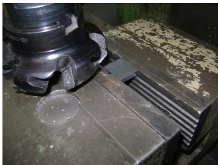
Figura 47 – Corpo-de-prova fixado na morsa hidráulica da fresadora CNC após a eliminação do sobrematerial mediante uma operação de faceamento.
