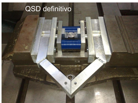
Figura 9. Dispositivo de Parada Súbita (QSD).
