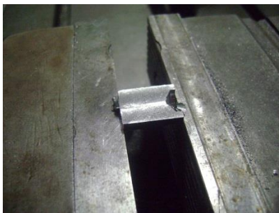
Figura 3. Corpo de prova após a eliminação do sobrematerial mediante faceamento.
