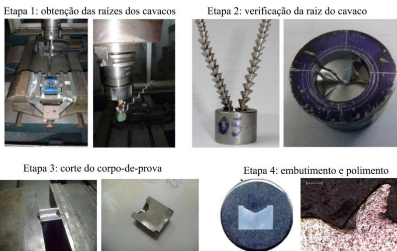
Figura 53 - Etapas da obtenção e preparação das raízes de cavaco.
