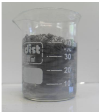
Figura 19 – Nanocompósito obtido por coagulação
