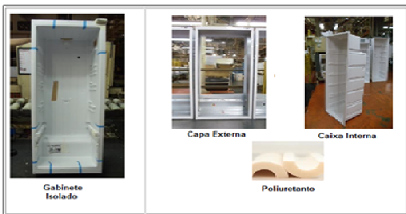
Figura 8 – Gabinete e suas partes isoladas.
