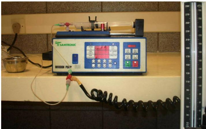
Figura 6 - Equipamento para determinação da pressão de ruptura da anastomose.
