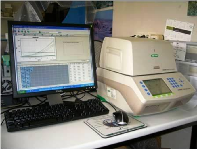
Figura 8 - Sistema de detecção de seqüências de DNAc, para determinação em PCR-RT
