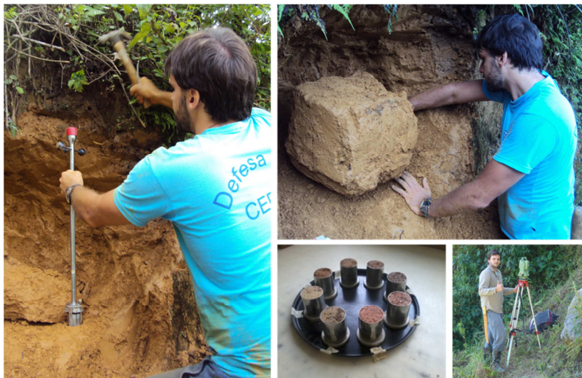
Figura 30 – Coleta de amostras, levantamento topográfico e amostras no laboratório
