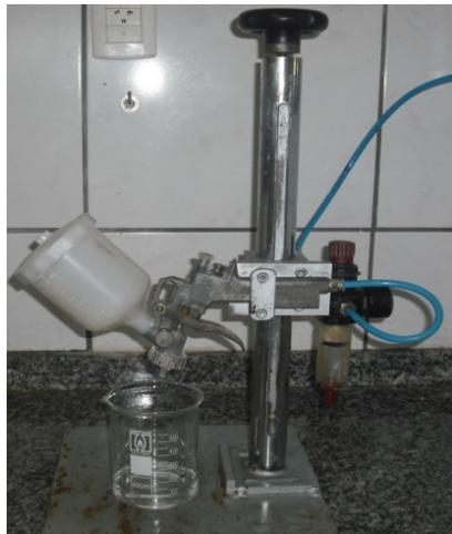
Figura 10 - Equipamento utilizado para pulverizar o esmalte sobre a solução de cloreto de cálcio.
