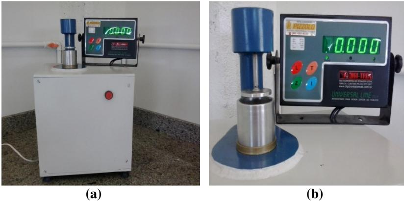
Figura 11 - (a) Equipamento utilizado para determinar a resistência mecânica a verde das granilhas, (b) detalhe do punção superior, porta-amostra e indicador digital.
