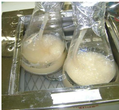
Figura 12- Cultivo de Bacillus subtilis em frascos com aeração e temperatura de 30 \text{ }^{\circ}\text{C} mantida com banho Maria
