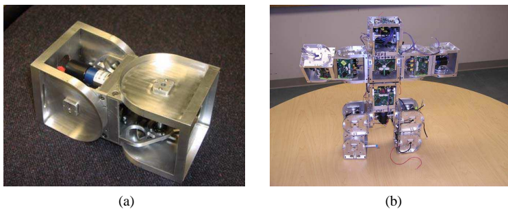
Figura 6: 6a: Módulo SuperBot [Salemi et al. 2006], 6b: Uma configuração com seis módulos SuperBot [Salemi et al. 2006].
