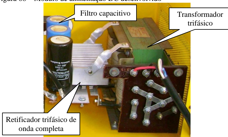
Figura 68 – Módulo de alimentação DC desenvolvido
