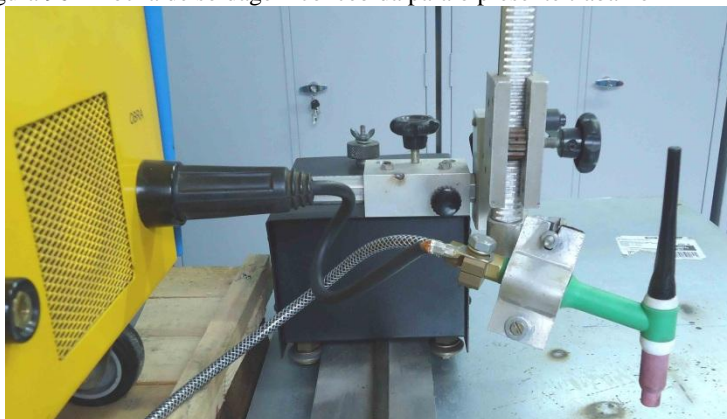
Figura 96 – Tocha de soldagem concebida para o presente trabalho
