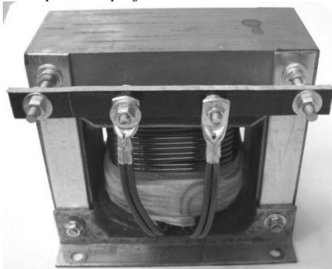
Figura 1 – Indutor de potência projetado e construído.
