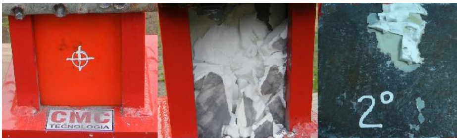
Figura 28 - Ensaio balístico da amostra 2 da cerâmica balística 92%: (a) vista frontal antes e (b) depois do impacto do projétil 7,62x51 AP e (c) após retirada do suporte e limpeza dos fragmentos.
