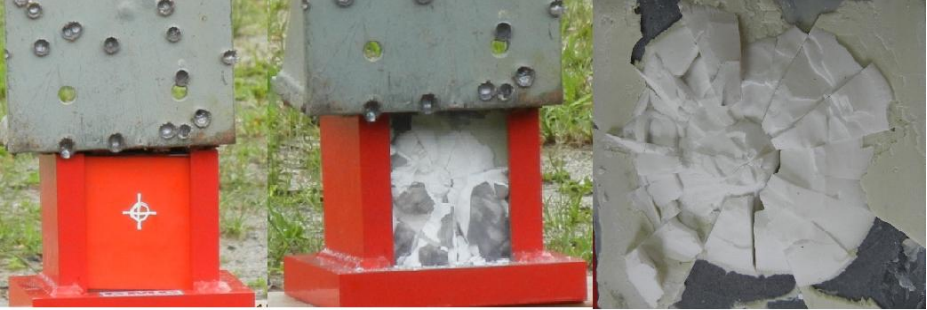
Figura 26 - Ensaio balístico da amostra 1 da cerâmica balística 92%: (a) vista frontal antes do impacto, (b) vista frontal após o impacto do projétil 7,62x51 AP e (c) vista frontal da placa metálica após retirada do suporte e limpeza dos fragmentos.
