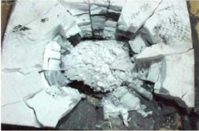
Figura 7 – Pastilha de cerâmicas de alumina após impacto balístico. Fonte: Couto (2011).
