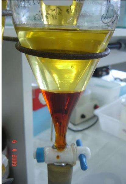
**Figura 12.** Separação das fases na extração do glicerol de biodiesel.
