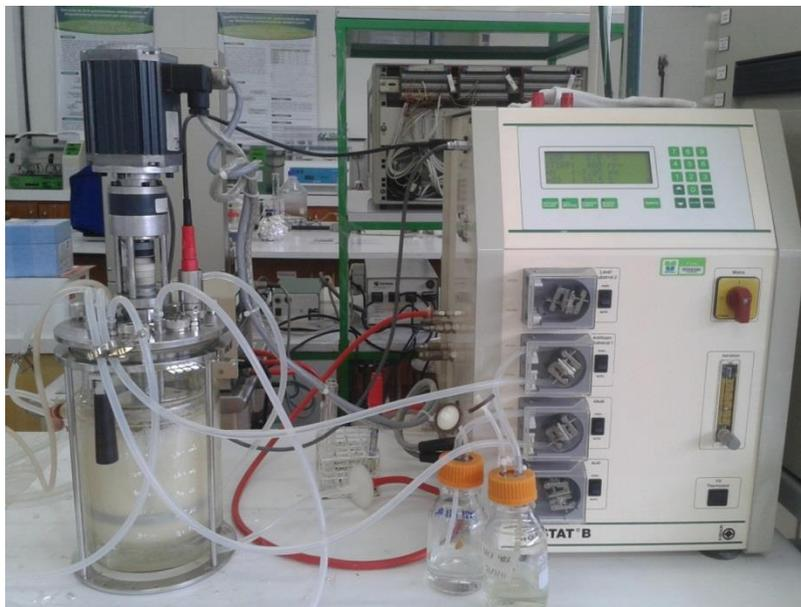
**Figura 6.** Dispositivo experimental de cultivo em biorreator.
