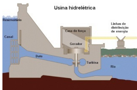
Figura 2 – Representação da geração de energia elétrica por usina hidrelétrica.
