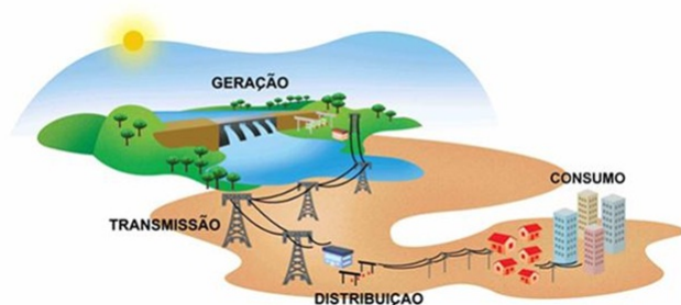
Figura 8 – Caminho percorrido pela energia elétrica desde a fonte de geração até os consumidores finais.
