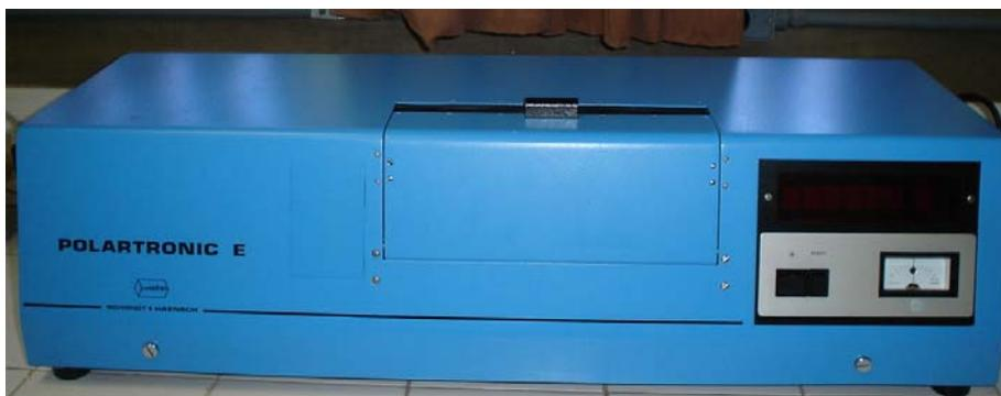
Figura 3 – Polarímetro utilizado na determinação da rotação óptica
