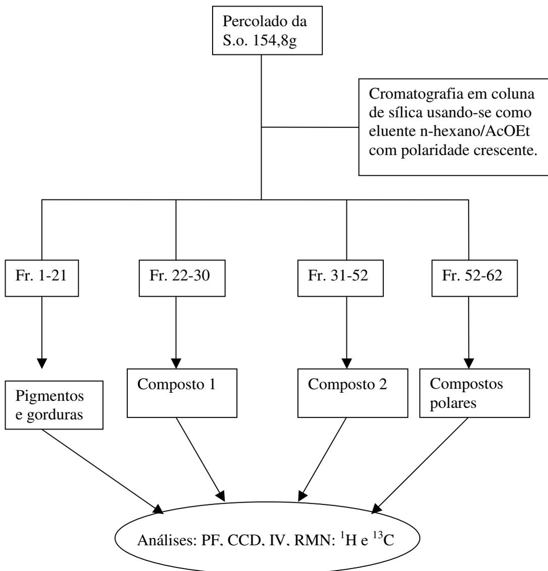
Fluxograma 1: Representação esquemática do isolamento dos compostos do Percolado.
