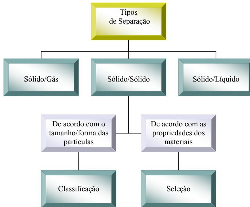
**Figura 2** - Representação esquemática dos tipos de separação.
