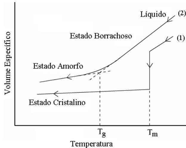
**Figura 1** - Gráfico do volume específico *versus* temperatura do comportamento térmico de um polímero amorfo e um polímero semicristalino.
