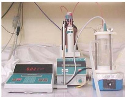
**Figura 2** – Sistema de Titulação Potenciométrica
