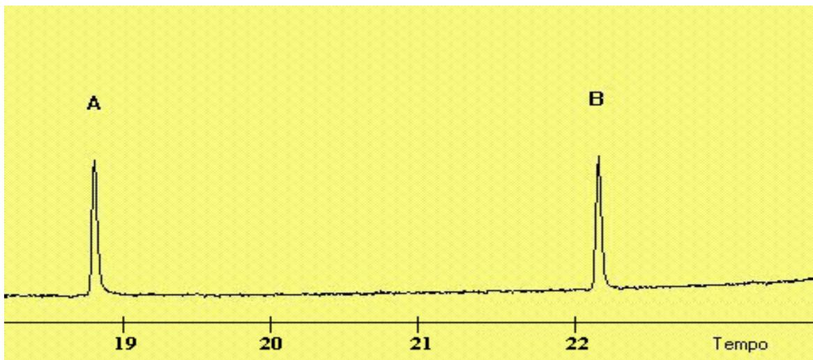
Figura 1-Sequência de eluição por tempo de retenção (min) dos padrões: A- estearato de metila C18:0 (18.780 min); B-metil cis-13-docosenoato C23:1 (22.107 min)
