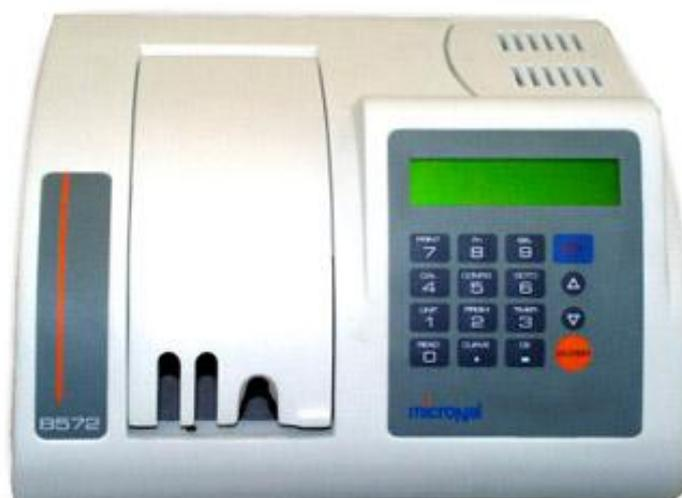
**Figura 5:** Espectrofotômetro visível modelo Micronal B-572.
