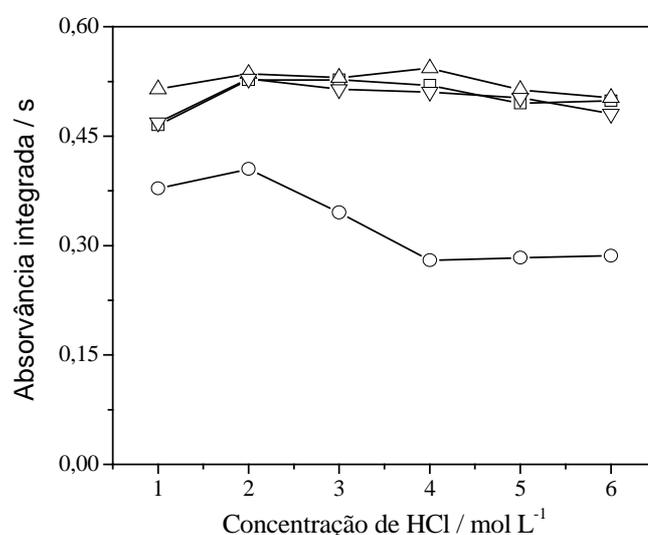
**Figura 5.** Efeito da concentração de HCl no sinal de absorvância para algumas amostras e em uma solução aquosa obtida por CV-GF AAS. Concentração de HCl no frasco reacional. (— △ —) BCR 186 (9,9 µg L<sup>-1</sup>), (—○—) GBW 9101 (10,8 µg L<sup>-1</sup>), (—△—) DOLT-2 (10,8 µg L<sup>-1</sup>) e (—▽—) solução aquosa em meio de TMAH (10,0 µg L<sup>-1</sup>).
