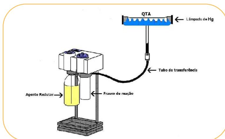
**Figura 1.** Sistema MHS-15 de geração química de vapor com atomizador de quartzo.
