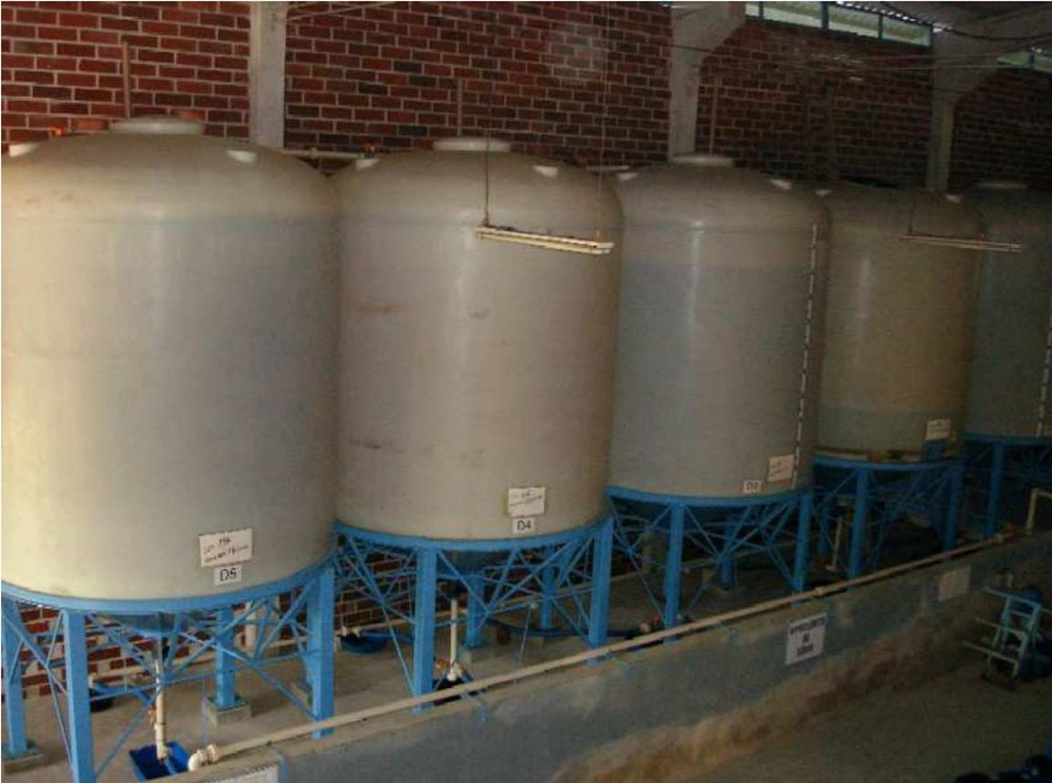
**Figura 8.** Foto dos decantadores no interior da fábrica.
