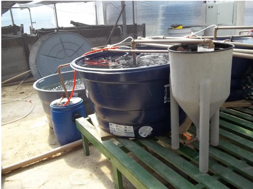
Figura 4 - Unidade experimental, da direita para a esquerda: decantador, tanque de peixes, sump e biofiltro.
