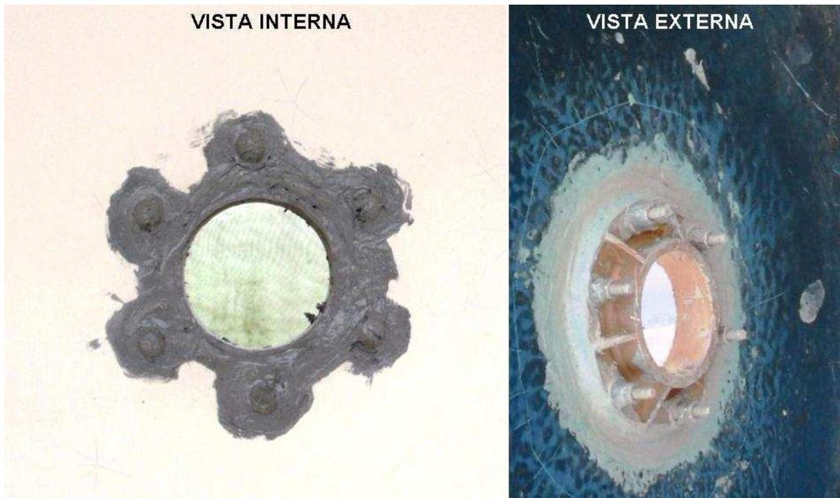
Figura 4: Flange de esgotamento sem ressalto
