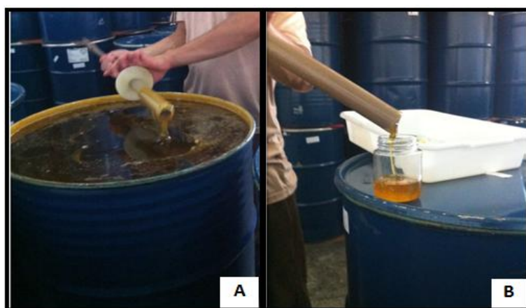
Figura 3: Retirada das amostras de mel com o cano amostrador (A) e transferência da amostra a frasco coletor (B).
