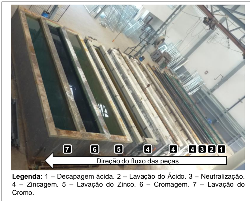
Figura 13 – Tanques do processo galvânico da empresa parceira.
