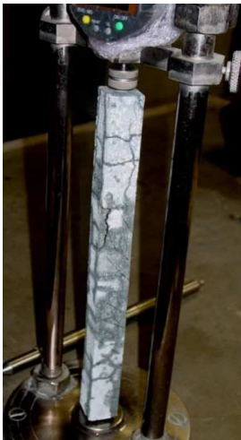
Figura 11 – Medição das barras de argamassa (ABCP apud . JESUS, 2008).
