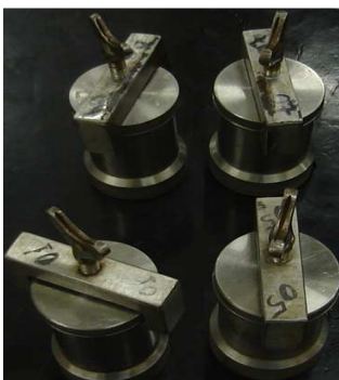
Figura 17 – Reatores metálicos utilizados no ensaio.
