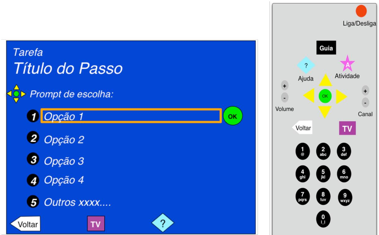
Figura 4.18 Especificação gráfica de uma tela de menu para TV digital e de um controle remoto, projetados como componente genérico para uso nas aplicações-protótipo, com base no processo de elaboração de argumentos
