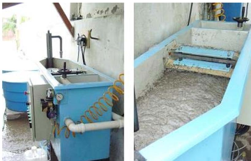
Figura 1. Reúso de água usando o FF em empresa de ônibus de Porto Alegre
