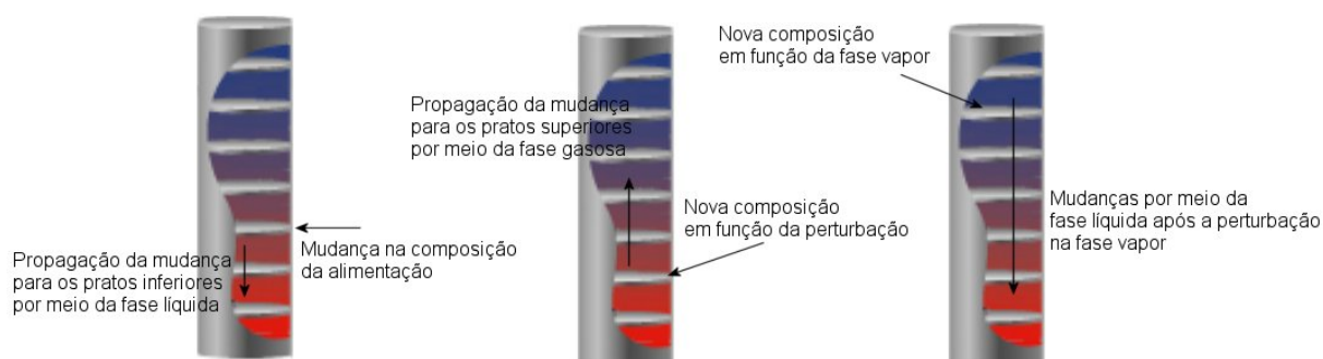
Figura 2.1 Ilustração do comportamento dinâmico de uma coluna de destilação decorrente de uma mudança na composição da alimentação.
