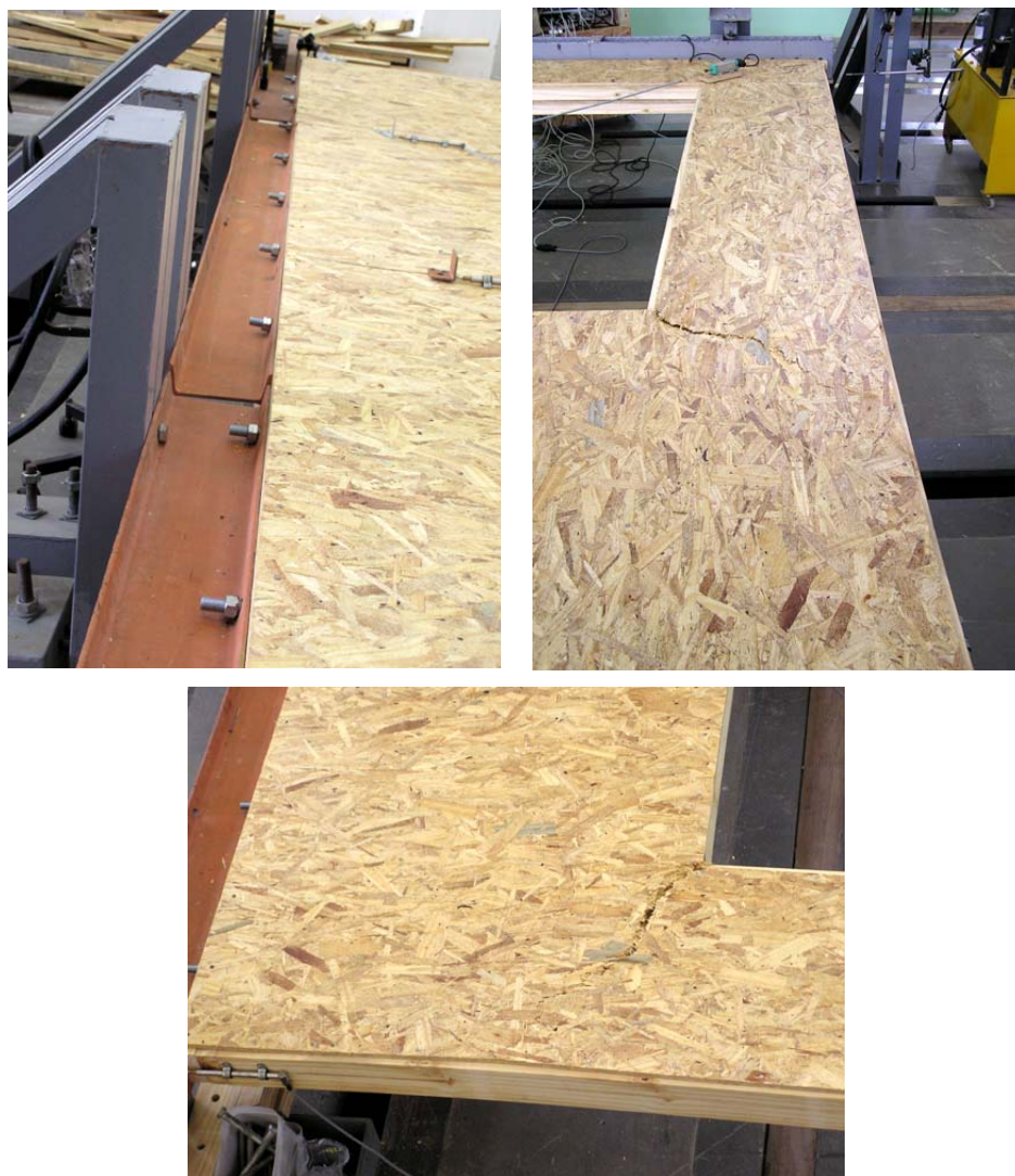
Figura 78 - Ensaio dos protótipos P488-2J-pf. À esquerda: movimentação mínima das chapas sob força máxima; ao centro e à direita: rasgamento das chapas de fechamento.
