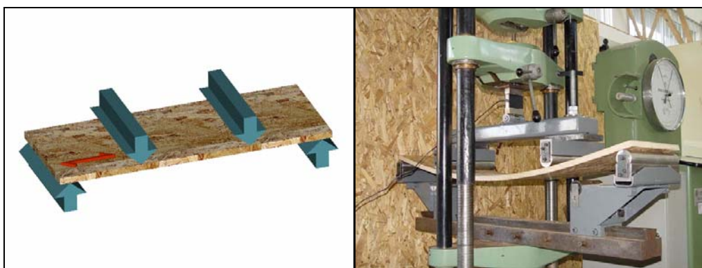
Figura 38 - Ensaio de flexão longitudinal da chapa de OSB.
