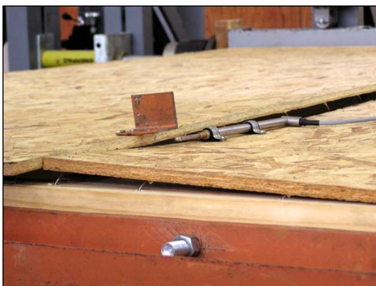
Figura 63 - Arrancamento dos pregos no protótipo com prego 16x24 liso.
