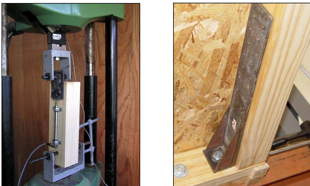
Figura 54 - Ensaio da ligação pregada para definição da quantidade de pregos no dispositivo de ancoragem. (a) Vista co corpo-de-prova da ligação; (b) Dispositivo de ancoragem preso ao montante extremo.
