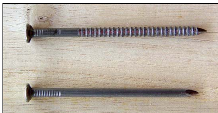
Figura 44 - Tipos de pregos usados na pesquisa: anelado e liso.
