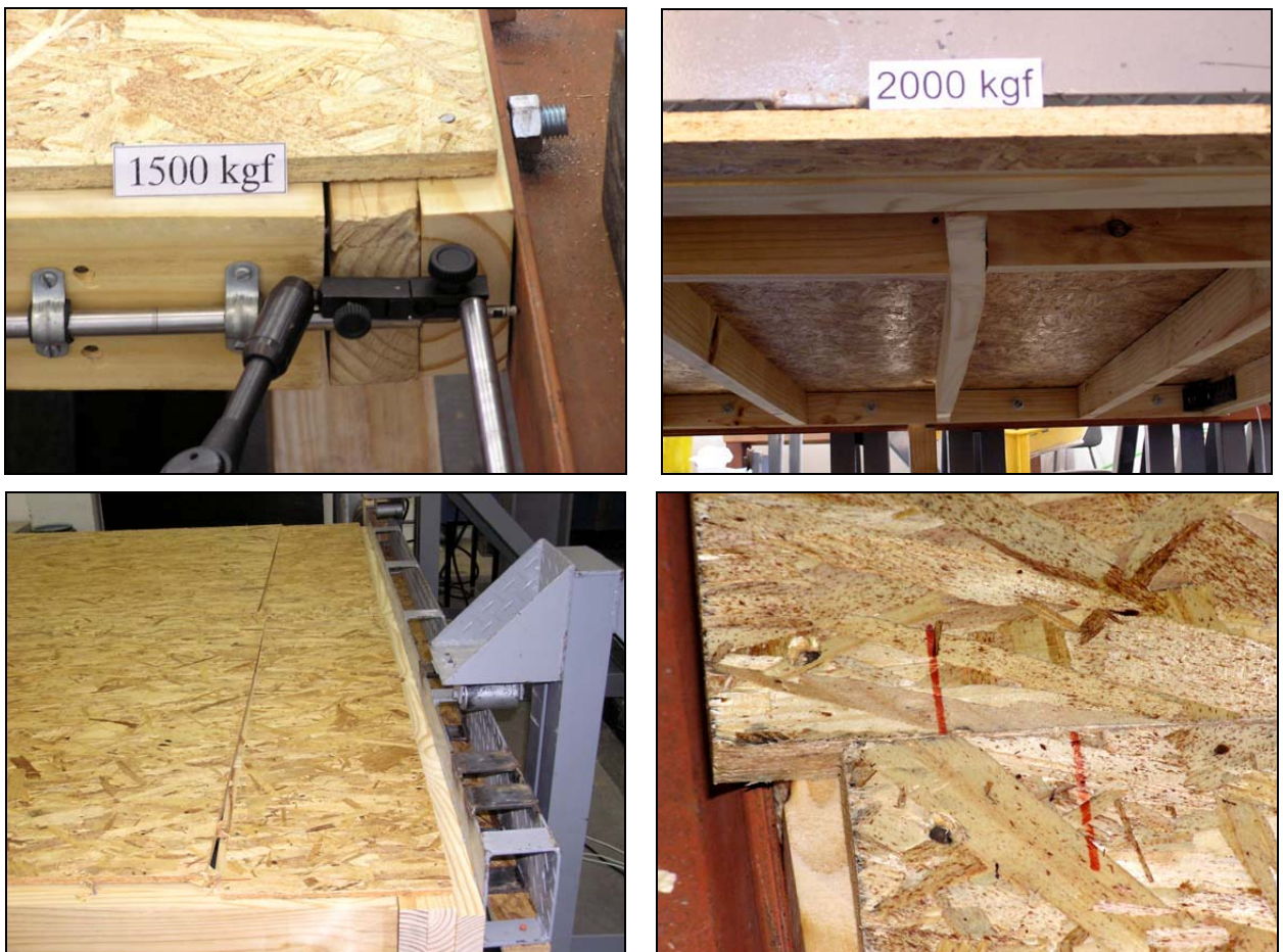
Figura 61 – Detalhes do ensaio das paredes P244 e P244-pregoliso.
