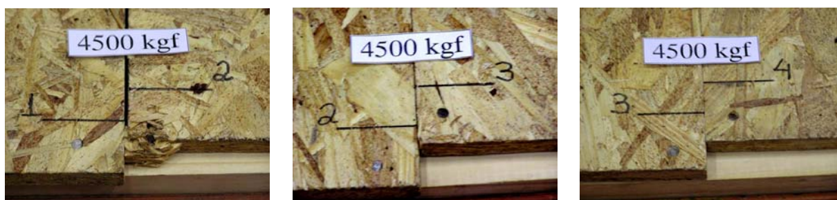
Figura 68 - Separação semelhante entre as chapas de fechamento junto à base, no ensaio da parede P488.
