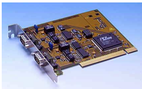
Figura 5.11: Placa CAN-PCI/200 da empresa ESD para controle da rede CANbus.
