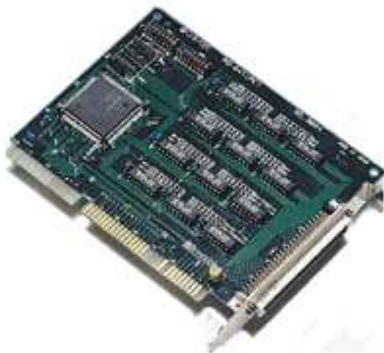
Figura 5.8: Placa de E/S PO64T da empresa Contec. Fonte: http://www.contec.com/
