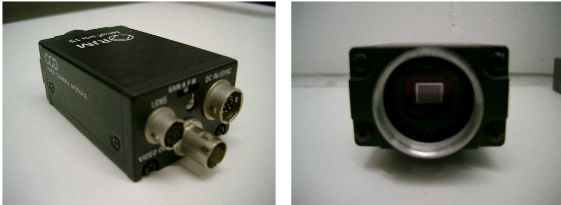
Figura 5.9: Camera analógica Sony CCD XC-75CE com sensor CCD de 1/2 polegada. Fonte: Pavim [1].
