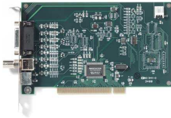
Figura 5.12: Placa de aquisição PXC200A da empresa Imagenation Technology. Fonte: Pavim [1].
