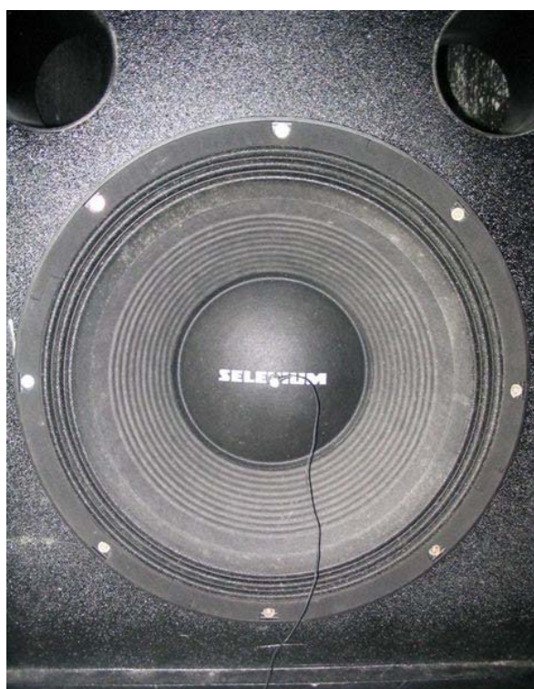
Figura 63. A fixação do acelerômetro ao alto-falante.
