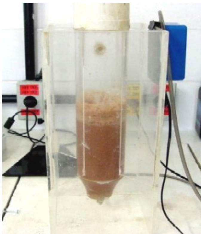
Figura 5.3: Efluente in natura (não-tratado) antes da adição do coagulante.
