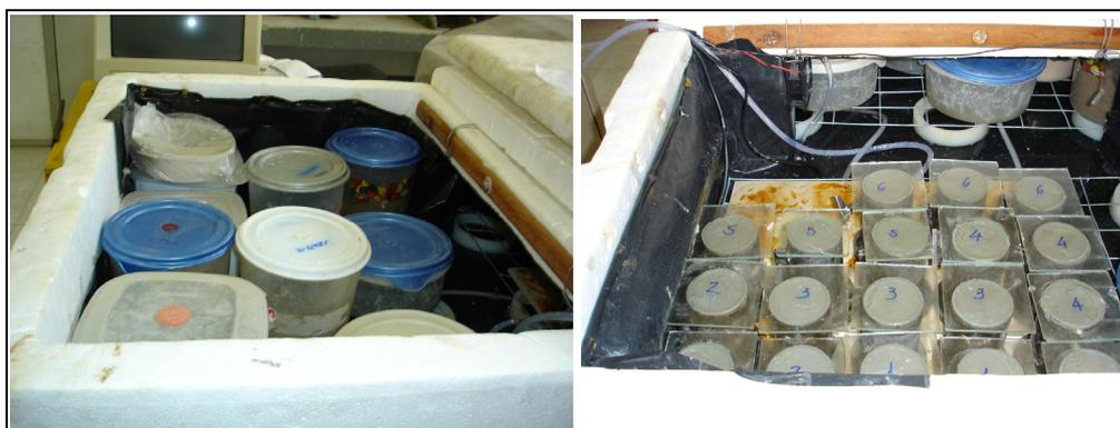
Figura 31 – Caixa com os materiais utilizados e corpos-de-prova moldados.
