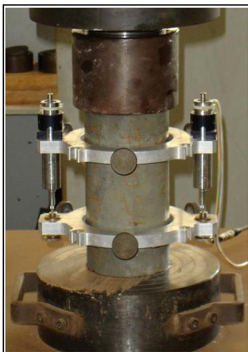
Figura 32 – Aparato acoplado ao corpo-de-prova para ensaio de módulo de deformação.
