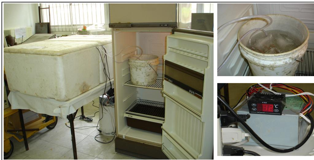
Figura 30 – Fotografias do aparato montado para resfriamento do ar.
