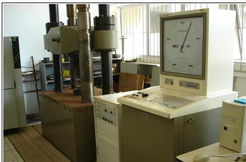
Figura 28 – Prensa eletrônica utilizada na execução dos ensaios de ruptura à compressão.
