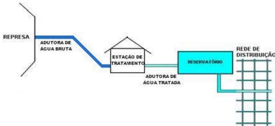
**Figura 5.** Esquema básico da captação e tratamento de água do Sistema de abastecimento Cubatão-Pilões.
