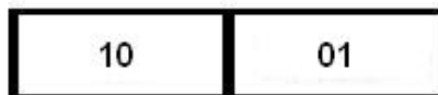
Figura 69 - Instrução enviada pelo PC a unidade base, solicitando o início de leituras da remota 01.
