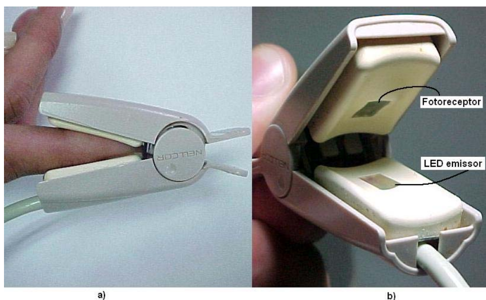
Figura 35 - Sensor para fotopletismografia marca Nellcor utilizado neste trabalho. Somente foram aproveitadas suas partes mecânicas, substituindo-se os dispositivos optoeletrônicos originais por outros com características conhecidas. Em (a) o sensor em uso, e em (b) pode ser visto a localização de suas partes internas.
