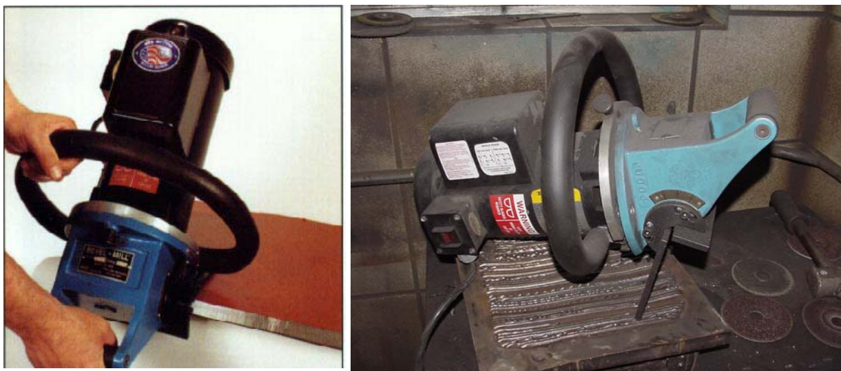
Figura 4.2 - Chanfradeira manual utilizada.
