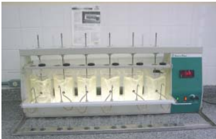
Figura 4-5 - Equipamento de jarreste utilizado nos experimentos
