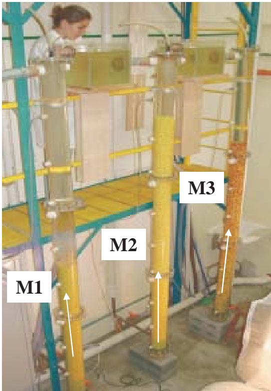
FOTO 12 - sistema piloto de floculação. Ensaio com os materiais m1, m2 e m3
