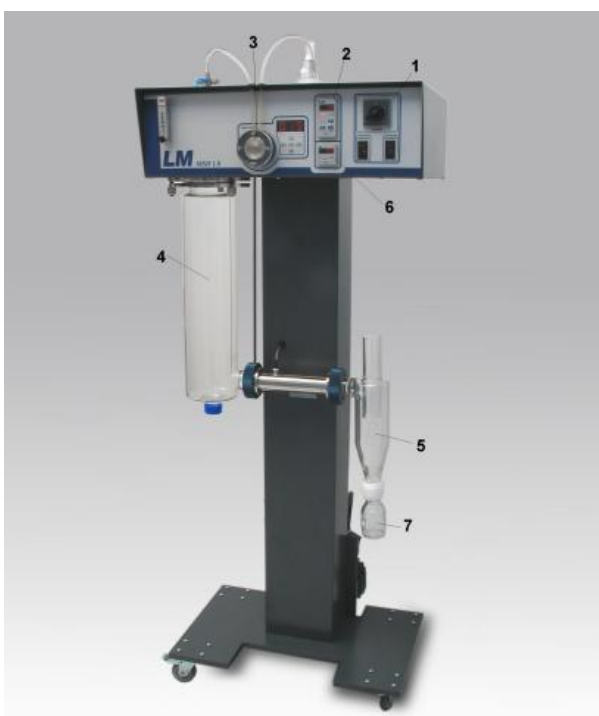
Figura 5. Fotografia de um spray dryer (Fonte: www.labmaqdo brasil.com.br ). Componentes do equipamento: 1 – Chave geral; 2 – Controle de aquecimento; 3 – Controle de bombeamento de líquido; 4 – Câmara de secagem; 5 – Separador de pó seco; 6 – Indicador de temperatura de saída do produto; 7 – frasco coletor do pó seco.
