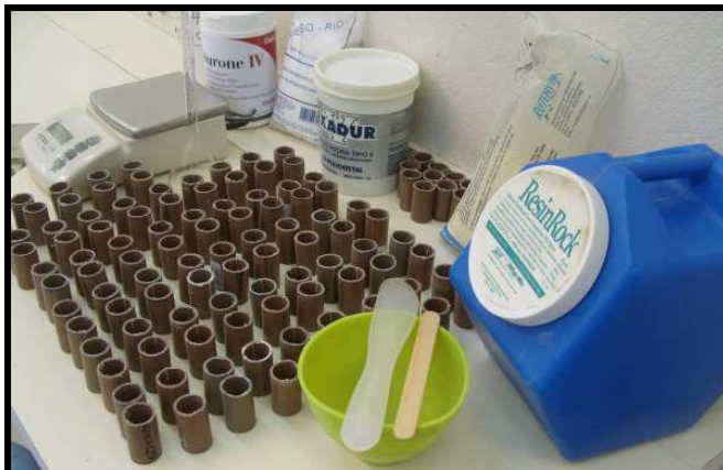
Figura 1: Preparo das amostras para o teste de compressão
