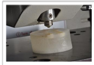
Fig.16-17 - Execução do teste de microdureza Vickers
