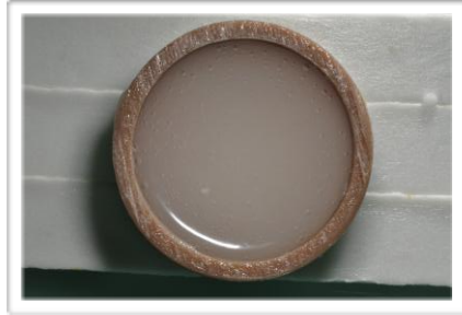
Fig.9-10 - Inclusão dos espécimes em resina epóxica.
