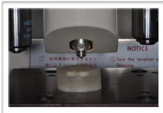
Fig.16-17 - Execução do teste de microdureza Vickers
