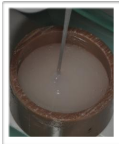
Fig.9-10 - Inclusão dos espécimes em resina epóxica.
