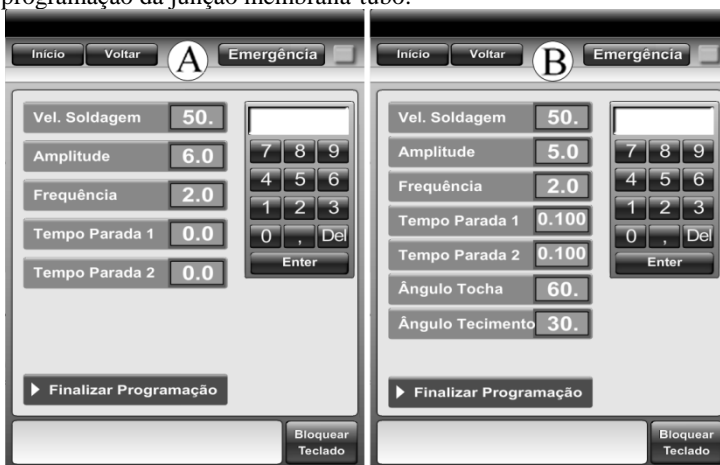
Figura 44 – Em (A) tela de programação da membrana e em (B) tela de programação da junção membrana-tubo.
