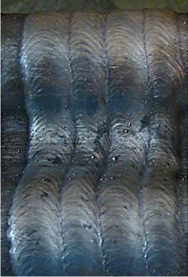
Figura 58 – Revestimento da parede na posição horizontal.
