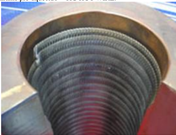
Figura 8 - Revestimento realizado pelo processo TIG com alimentação de arame pré-aquecido – TIG HOT WIRE.
