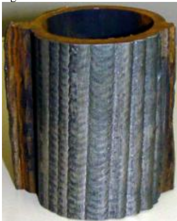
Figura 11 - Revestimento de Inconel 625 aplicado com PTA-P.
