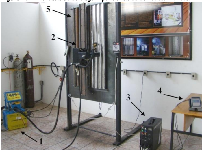
Figura 46 – Bancada de soldagem para ensaios de revestimentos.
