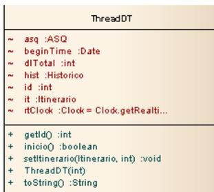
Figura 16 – Diagrama da implementação da Thread Distribuída
