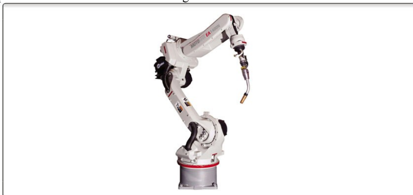
Figura 3 - Robô antropomórfico de 6 graus (X, Y, Z, A, B, C) de liberdade para posicionar/deslocar a tocha de soldagem.
