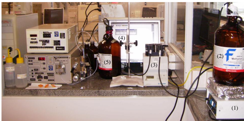
Figura 4.3 - Desenho esquemático e fotografia da configuração utilizada para estudos de adsorção e dessorção dos compostos BTX em coluna de leito fixo com carvão ativado.
